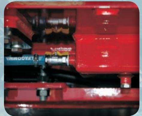
**Les robinets** de fermeture des réservoirs d'huile hydraulique et gasoil simplifient et plus rapides les travaux d'entretien.
