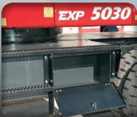
La **EXP5030** accepte des équipements d'un rayon d'action de 11 à 13 mètres et avec tous les genres d'outils disponibles pour la manutention : comme le grappin, l'électro-aimant, la pince à grumes, la benne-preneuse, la pince de tri, etc....
