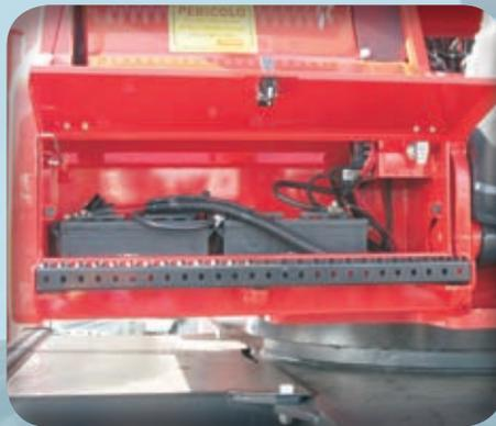
**Coffre à batterie** avec serrure pour une meilleure sécurité durant l'arrêt de la machine.
