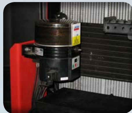
Graissage automatique en option pour l'équipement et la couronne d'orientation.
