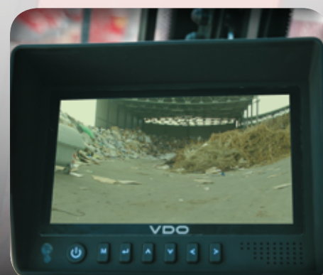
Caméra arrière avec écran couleur de 7 pouces en cabine (Possibilité d'installation sur flèche).
