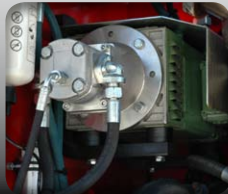
Génératrice pour électro-aimant , entraînée par un moteur hydraulique et montée sur silent-blocs.
