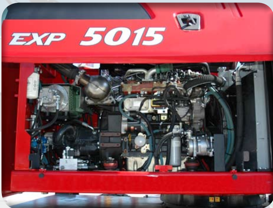
Grand capot , permettant un accès extrêmement aisé et sûr à tous les points d'entretien.
