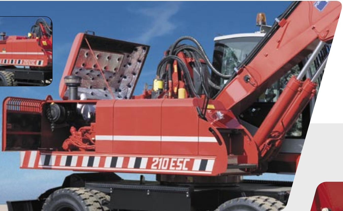
**Capot moteur:** les opérations d'entretien et de contrôle sont simples et faciles grâce à une excellente accessibilité. Les capots sont recouverts de matériel phono absorbant réduisant la propagation externe des bruits. Prises d'aération tournées vers le haut pour dévier les flux d'air et les bruits.
