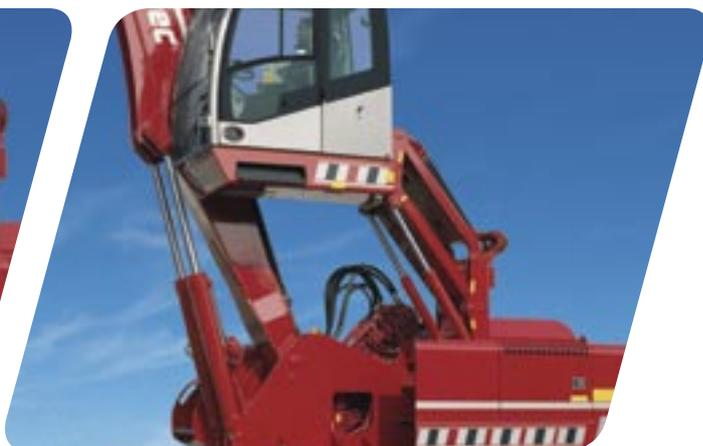
**Cabine de conduite** avec d'amples surfaces vitrées pour une meilleure visibilité, pare-brise glissant sous le toit, fenêtre latérale gauche s'ouvrant à compas, double essuie-glace, phares halogènes sur le toit de la cabine.
